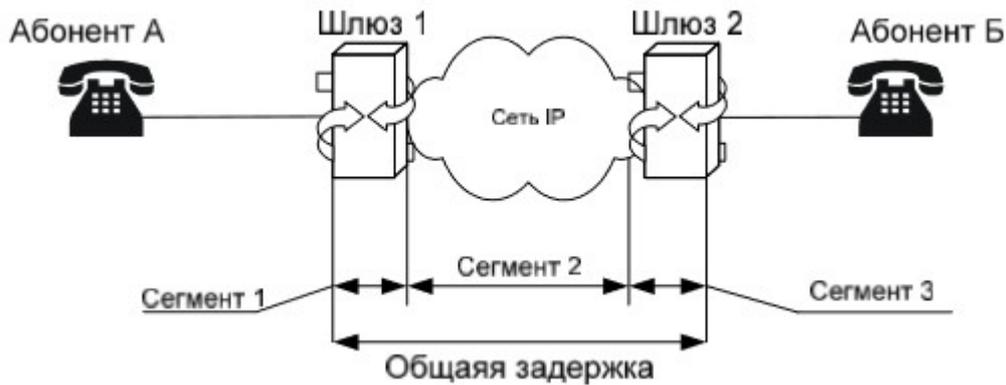
Рис. 12. Составные части задержки
